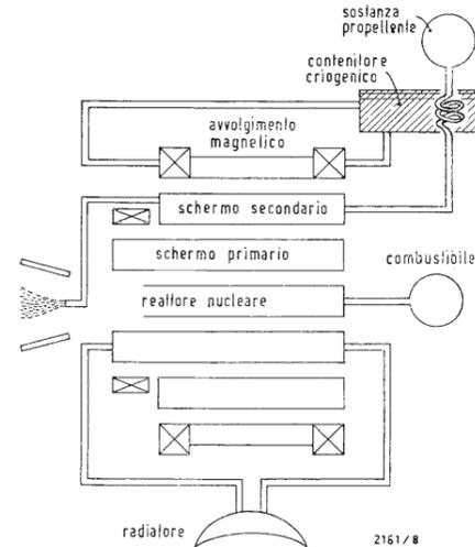
Fig. 6 - Schema di principio di un impianto di fusione termonucleare con avvolgimento magnetico, in filo in superconduzione, raffreddato in una cella criogenica isolata dall'alta temperatura del reattore di fusione con un doppio schermo termico.
