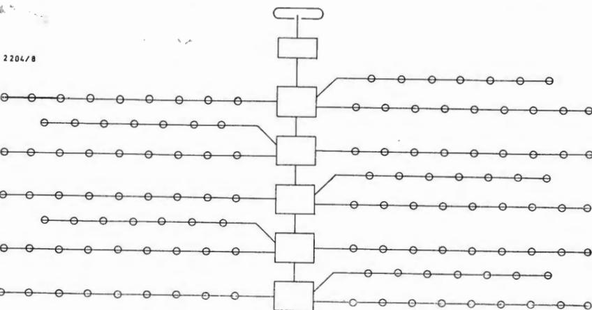
Fig. 2 - Esempio di distribuzione mediante amplificatori (distribuzione orizzontale).
