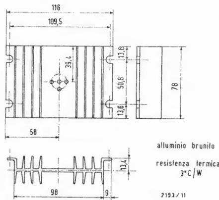
Fig. 7 - Caratteristiche fisiche dei radiatori di calore.
