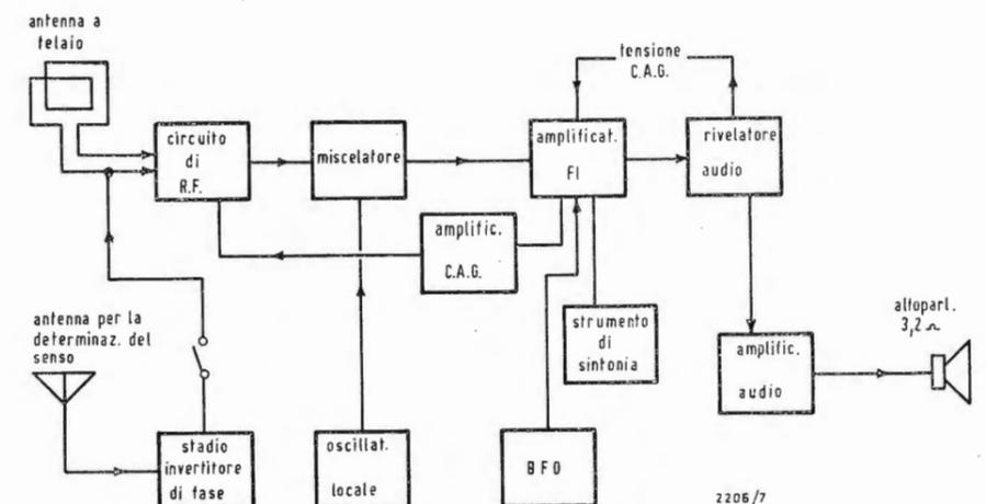
Fig. 2 - Schema a blocchi.
