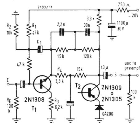
Fig. 1 - Il preamplificatore è costituito da due transistori accoppiati in continua, l'emettitore di T<sub>1</sub> è direttamente collegato alla base di T<sub>2</sub>.
