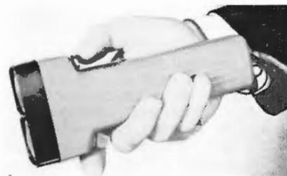
Apparecchio ultrasonico di ausilio ai ciechi in cui sono visibili il commutatore di gamma in alto e la combinazione interruttore di accensione e di disinserzione ed il controllo di volume in basso
