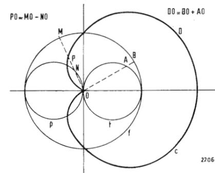
Fig. 4 - Diagramma di ricezione a cardioidale.
