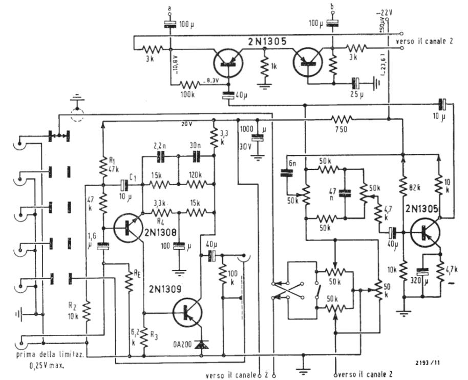
Fig. 5 - b) Schema completo del preamplificatore e dei circuiti correttori, per un canale; il secondo è uguale.
