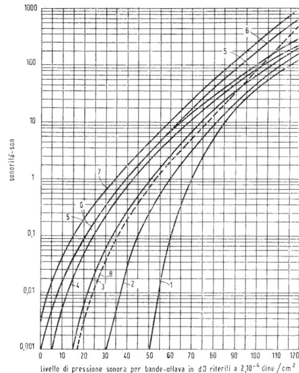
Fig. 4 - Diagramma per convertire i livelli sonori di bande a ottava in dB, a sonorità (forza sonori) in son.
