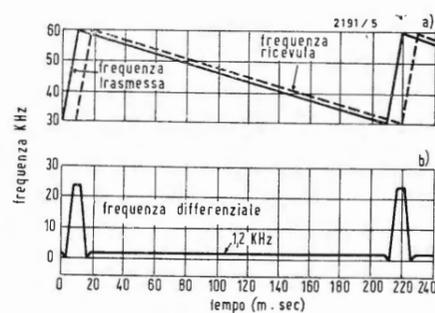
Fig. 3 - Grafico (a) delle frequenze trasmesse e ricevute, e (b) della frequenza differenziale, riferiti ad una comune scala dei tempi; velocità di variazione della frequenza durante la scansione principale = 3 kc/sec in 20 millisecondi; durata della scansione principale = 200 millisecondi; periodo di ritorno = 10 millisecondi; ritardo di eco = 8 millisecondi (distanza approssimativa di 1,2 m).
