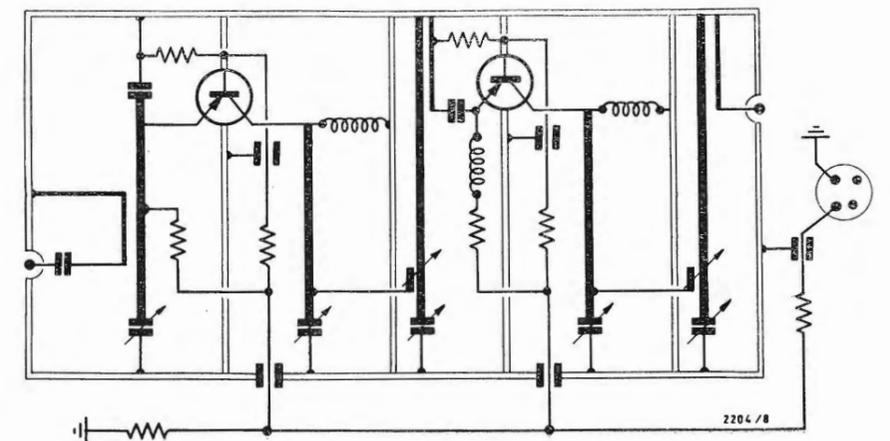
Fig. 6 - Amplificatore a 2 transistori per frequenza 500 MHz, larghezza di banda 10 MHz, guadagno in tensione 35 dB e consumo totale di solo 60 mW - Modello AUT della ELETTRONICA INDUSTRIALE.
