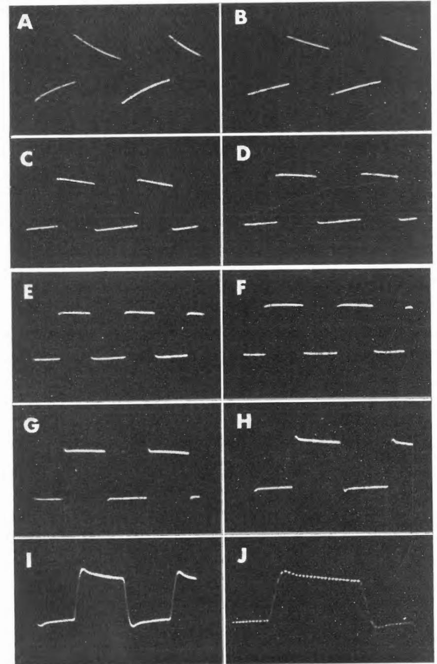
Comportamento dell'amplificatore in regime di onda rettangolare: in A, a 20 Hz; in B, a 40 Hz; in C, a 100 Hz; in D, a 500 Hz.
