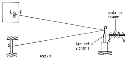
Fig. 6 - Principio dell'analizzatore a laminette vibranti.
