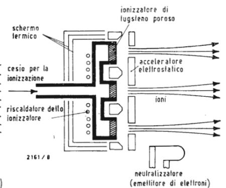
Fig. 3 - Accelerazione elettrostatica per mezzo di un campo elettrico costante di un plasma generato dalla ionizzazione atomica, di una certa sostanza, ad esempio cesio, per contatto con una superficie metallica portata ad alta temperatura.
