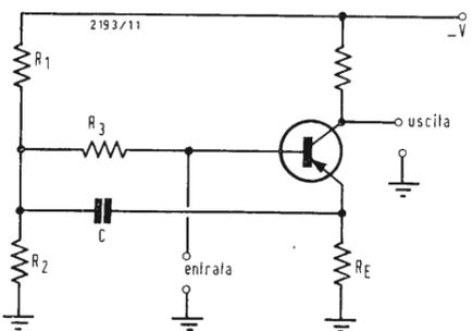
Fig. 2 - Schema di principio del circuito « bootstrap ».
