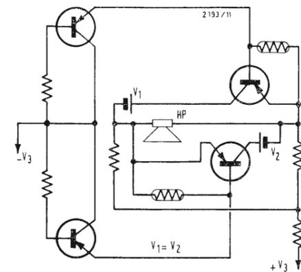
Fig. 4a I condensatori di accoppiamento all'altoparlante sono eliminati.
